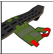
PULL TAUGHT AND TUCK VELCRO® BRAND FASTENER ENDS OF MOLLE STRAPS INTO BOTTOM MOST MOLLE LOOP
